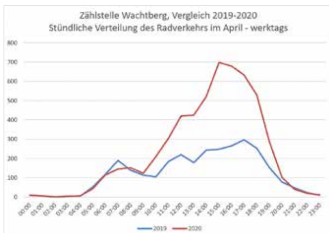
Vergleich der stündlichen Verteilung des werktäglichen Radverkehrs im April 2019 und 2020 an der Zählstelle in Wachtberg
