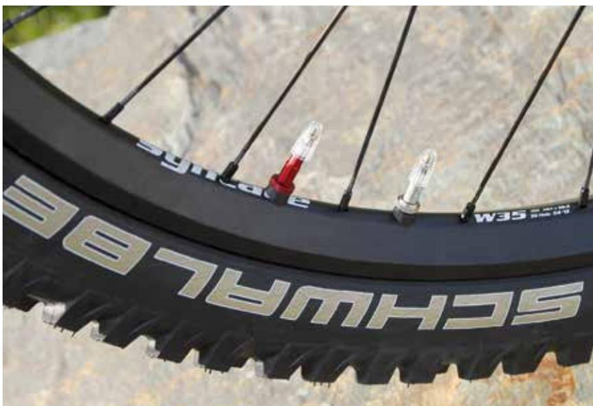
Nie wieder platte Reifen durch Durchschläge: Ein revolutionäres Doppelkammersystem macht es möglich, sehr geringe Luftdrücke zu fahren und damit die Reifenperformance enorm zu verbessern.
