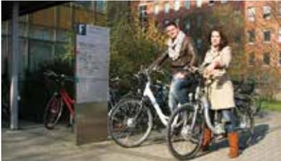
Bei diesen handelt es sich um sogenannte Pedelecs mit einer Höchstgeschwindigkeit von 25 km/h. Das Modell „Flyer“ verfügt über einen sehr leistungsstarken Akku. Ein voller Akku reicht – je nach Beanspruchung – für eine Strecke von etwa 30 bis zu 100 km. Um Transporte zu erleichtern, sind an den Ausgabestellen Fahrradtaschen zur Befestigung am Gepäckträger ausleihbar, die auch voluminöse Aktenordner aufnehmen können. Die Elektroräder können und sollen auch dazu beitragen, die
